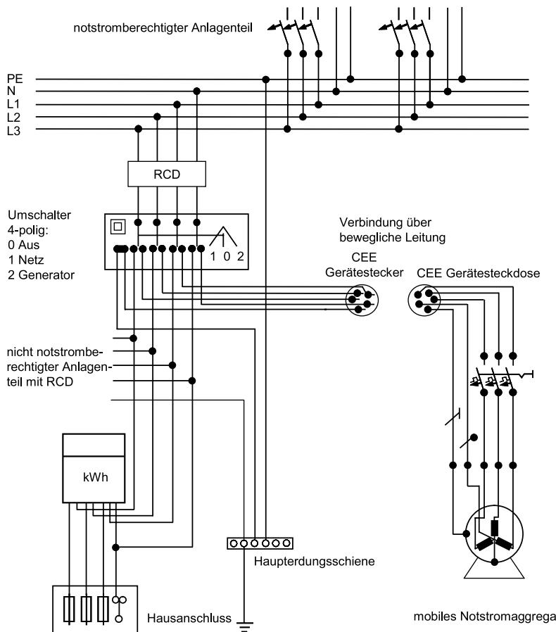
Anlage nur teilweise notstromberechtigt. Der notstromberechtigte Anlagenteil wird während des Generatorbetriebes als TN-S-System mit Schutz durch automatische Abschaltung betrieben (keine Trennung von Anlagen- und Betriebserder möglich).
